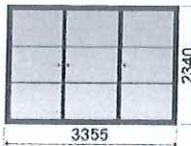
*Coulissant Aluminium LALOI Menuiseries Gamme CL32 Rupture thermique totale Finesse chicanes 35mm Classement A4 E9b VC2\* Uw : 1,4 W/m².K - SW 0,64 - Thv 0,65\* Acoustique : 34 (-1,-2) Db\* Laquage Qualicoat \*PF 2vtx 2800\*2700 avec Kit thermique Coulissant 3 vantaux 3 rails Larg 3355 mm x Haut 2340 mm*
