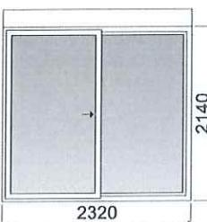
*Coulissant Aluminium LALOI Menuiseries Gamme CL32 Rupture thermique totale Finesse chicanes 35mm Classement A4 E9b VC2\*
