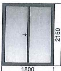
Coulissant Aluminium LALOI Menuiseries Gamme CL32 Rupture thermique totale Finesse chicanes 35 mm Classement A4 E9b VC2\*
